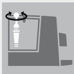
Wkręcanie filtra do zbiornika wody
